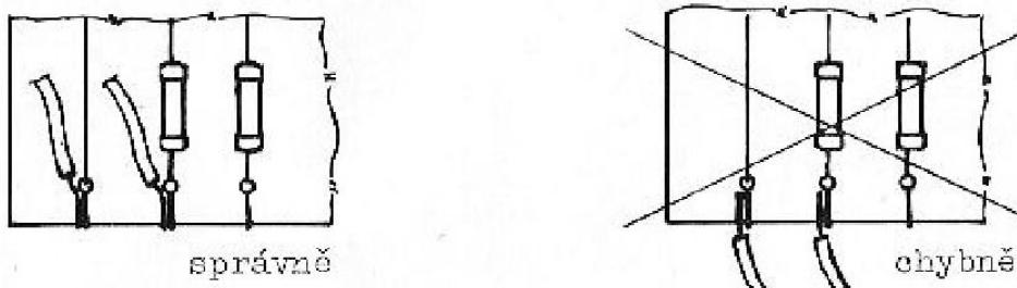
Kdybys je připájal obráceně, vodiče by bránily uzavření krabičky dnem s upevněnou baterií.
